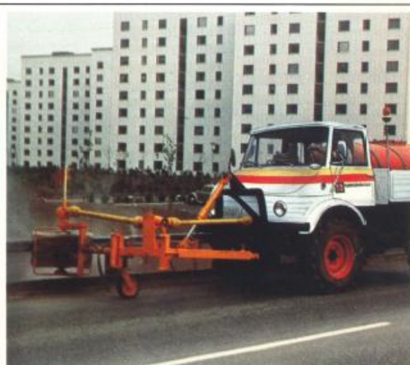
Tiekaiteen puhdistusta ja -pesua
