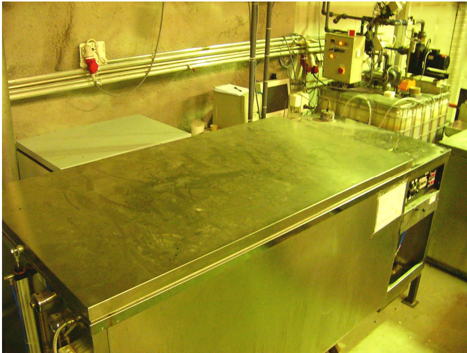
Kuva 2. Esimerkki menetelmän A mukaisesta jäädytys-sulatuslaitteesta (syklien ohjaus automatiikalla).
