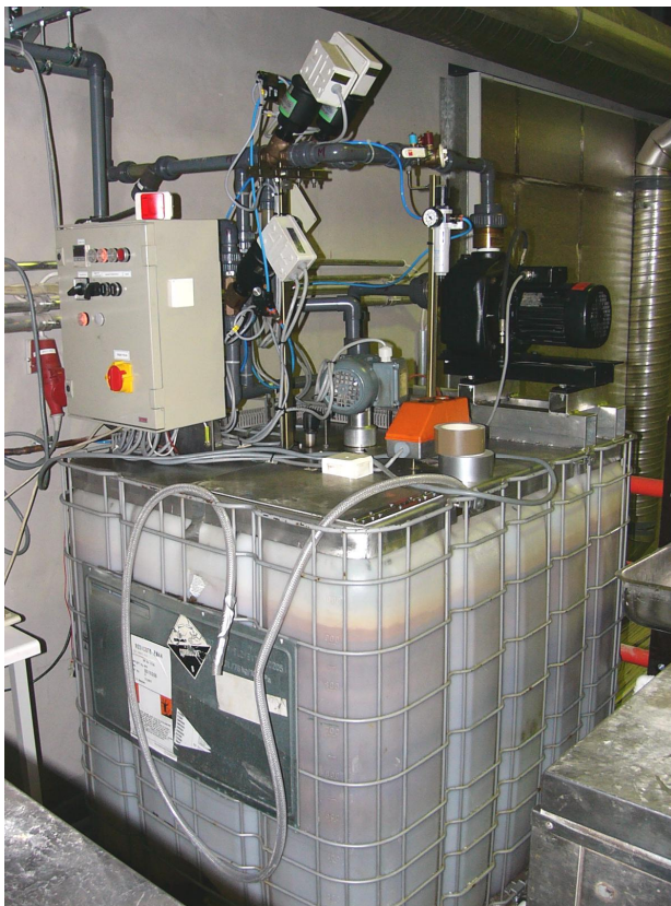
Kuva 3. Esimerkki menetelmän A mukaisen jäädytys-sulatuslaitteen ulkoisesta vesisäiliöstä ja sen varusteista.
