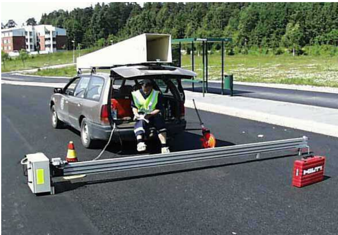
Kuva 11. Profilometrimittaukset käytännössä (Meripellontie)
