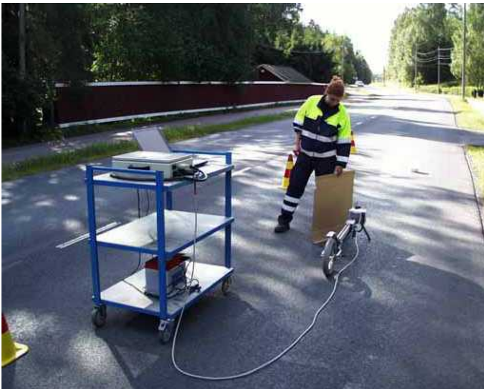
Kuva 61. Makrokarkeusmittaukset (profilometrimenetelmä) käytännössä
