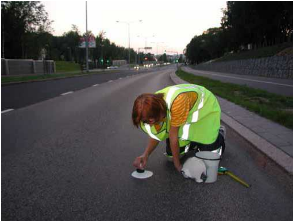
Kuva 60. Sand Patch -mittaukset käytännössä
