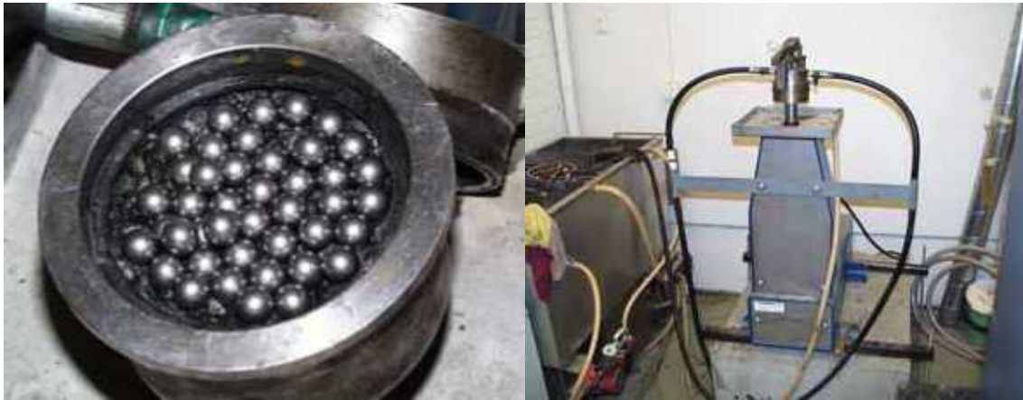
Kuva 10. Prall-laite, johon kuuluu vesikierron (+5°C) takia myös lauhdeallas. Sylinterissä olevan koekappaleen päällä on 40 teräskuulaa, jotka kuluttavat kappaletta sylinterin liikkeessä vertikaalisesti 950 kierrosta minuutissa.
