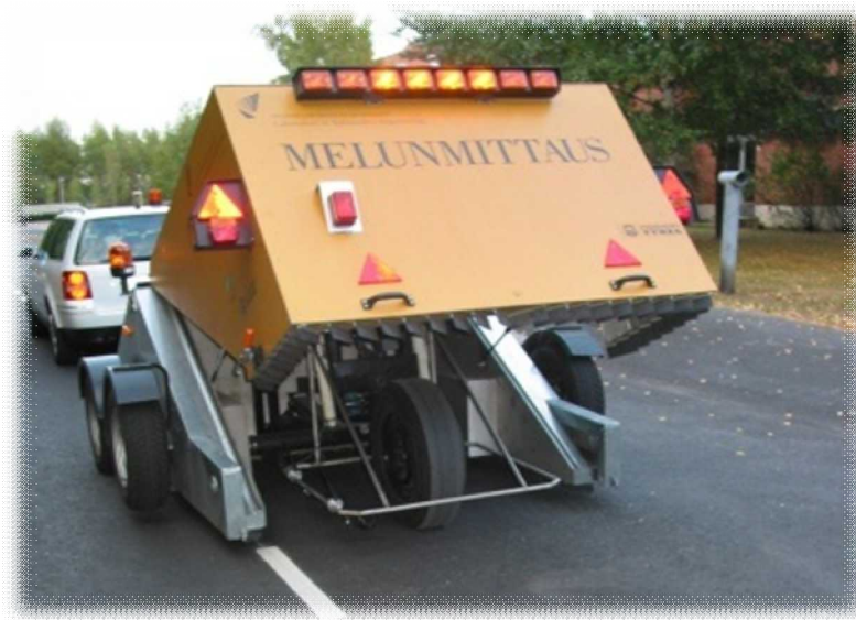
Kuva 2: Aalto-yliopiston auto- ja työkonetekniikan CPX-melumittauslaite, jossa mittausrengas sijaitsee vaunun keskellä (Panu Sainio).
