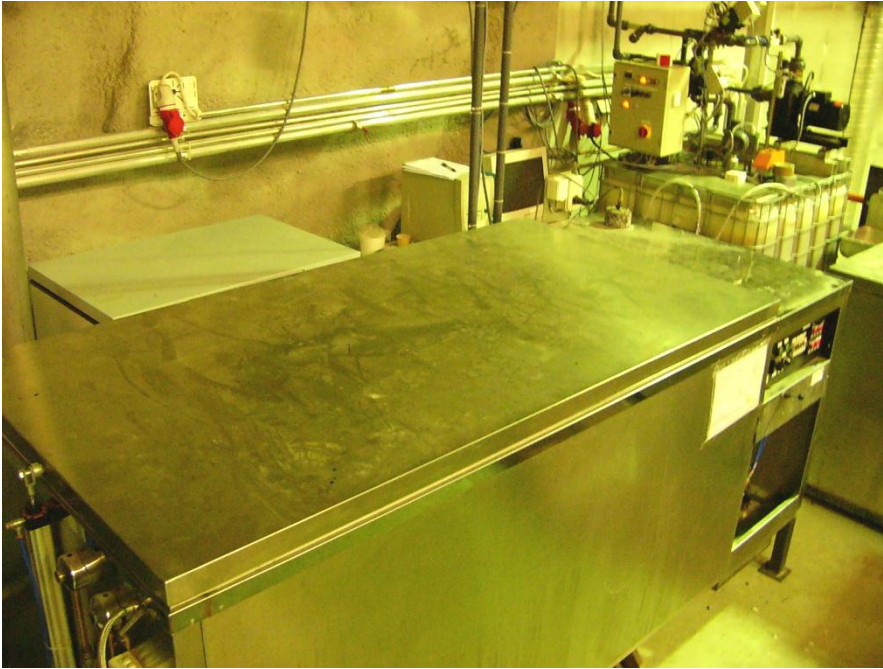
Kuva 3. Esimerkki automaattisella ohjauksella varustetusta jäätymis-sulamislaitteesta varusteineen.
