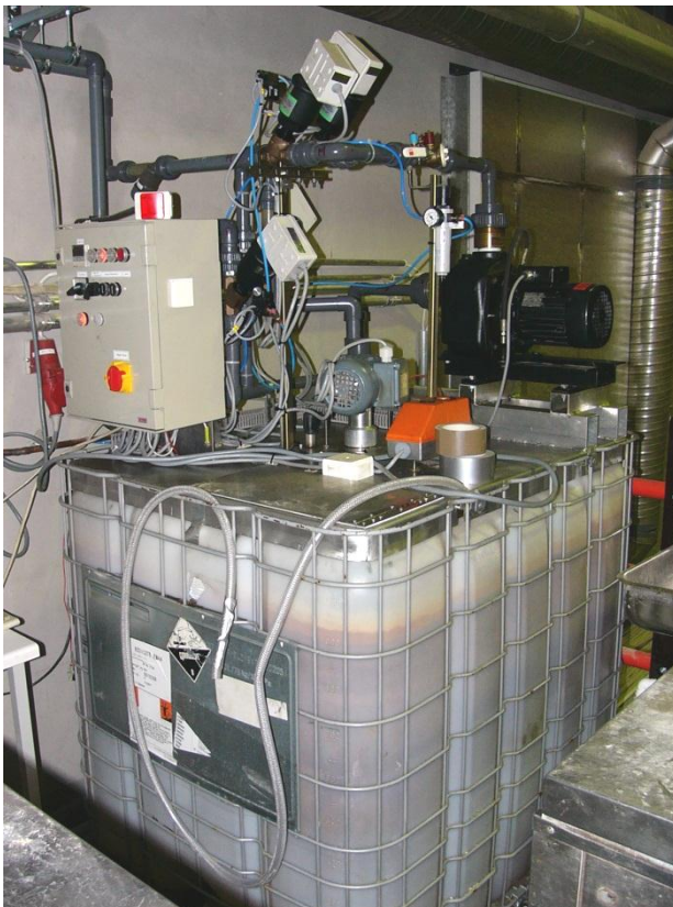
Kuva 4. Esimerkki automaattisella ohjauksella varustetun jäätymis-sulamislaitteen ulkoisesta vesisäiliöstä ja sen varusteista.
