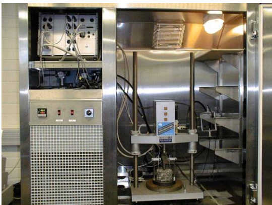
UTM-laite, jolla voidaan määrittää mm. deformaatiota
