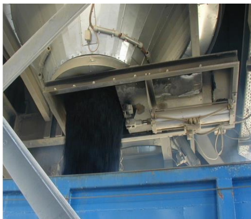
Massa pudotetaan varastosiilosta kuljetusauton lavalle
