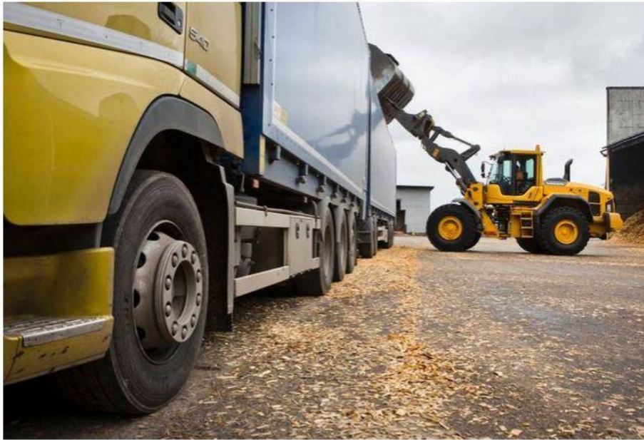
Kuvan hakerekan kokoisten 76-tonnisten kuljetusyhdistelmien paripyörävaatimukset hiertävät kuljetusliikkeitä. Suuremmista kuljetuksista saatavat säästöt valuvat rengas- ja polttoainekustannuksiin. Kuva: Elias Lahtinen
