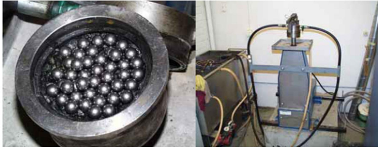
Kuva 10. Prall-laite, johon kuuluu vesikierron (+5°C) takia myös lauhdeallas. Sylinterissä olevan koekappaleen päällä on 40 teräskuulaa, jotka kuluttavat kappaletta sylinterin liikkeessa vertikaalisesti 950 kierrosta minuutissa.
