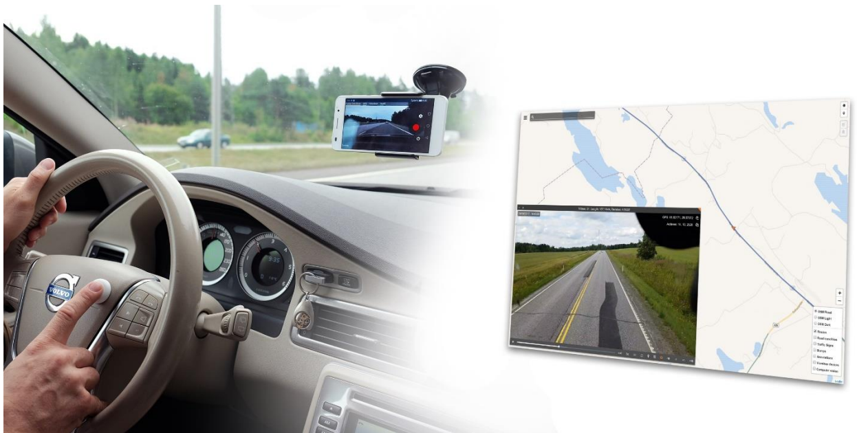
Kuva 7.1. Auton tuulilasin sisäpuolelle kiinnitetty puhelin tuottaa aineiston konenäköanalyysia varten.
