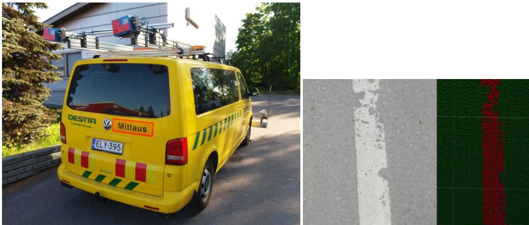
Kuva 5.1. Destian laserskannereilla varustettu mittausajoneuvo ja esimerkki tiementöinnin mittauksesta.
