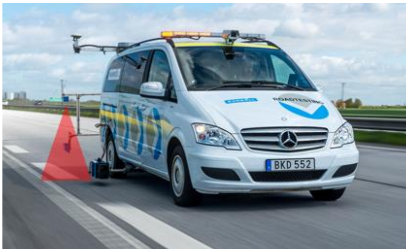
Kuva 6.1: Rambollin mittausauto ja kuva miten linjalaseri mittaa.
