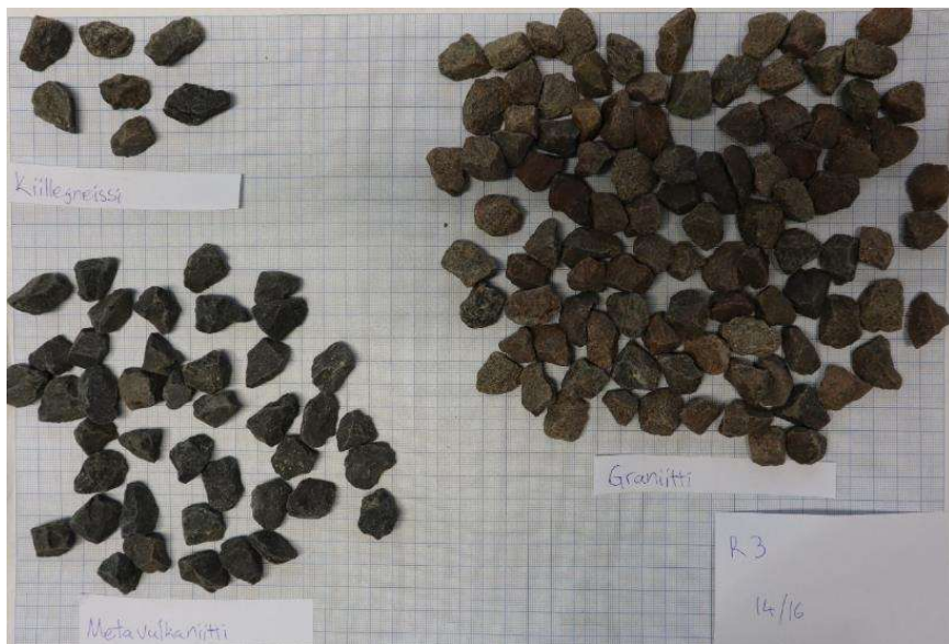
Jyrsinrouheen kiviainesta SMA-päällysteestä
